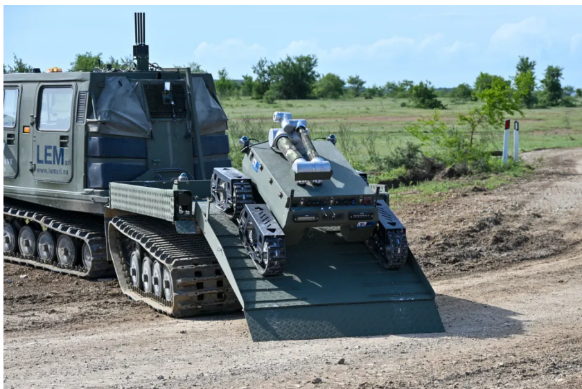
Fase di scaricamento del LEM Small Tracked UGV ArmScout1 dalla rampa posteriore del BV206. Fonte Esercito Italiano.
