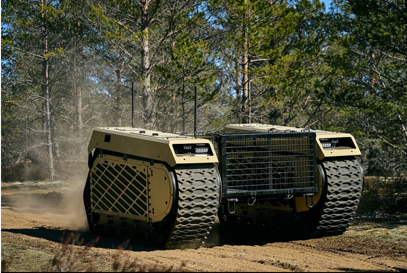
Il veicolo terrestre senza equipaggio (UGV) THeMIS di quinta generazione. Foto: Milrem Robotics, 16 aprile 2019 / Wikimedia Commons.
