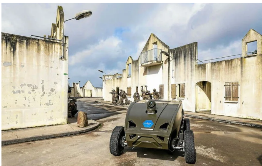
Hermione: il veicolo terrestre a idrogeno che trasporta droni e si rifornisce in 3 minuti
