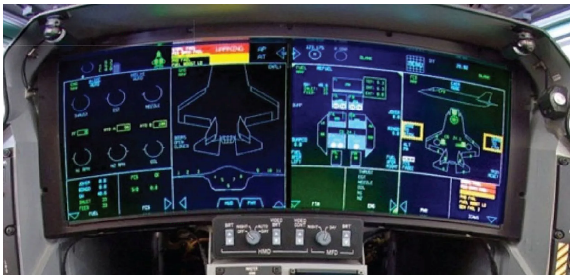
Interfacce e sistemi di bordo dell'F-35: l'architettura digitale consente aggiornamenti rapidi del software e integrazione continua delle capacità AI. Fonte: Lockheed Martin / U.S. Air Force
